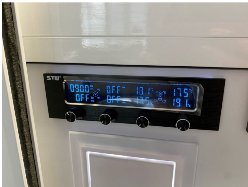
Рис. 2. Блоки регуляции и контроля над температурой в культивационной установке и количестве оборотов в минуту для каждой колбы.
