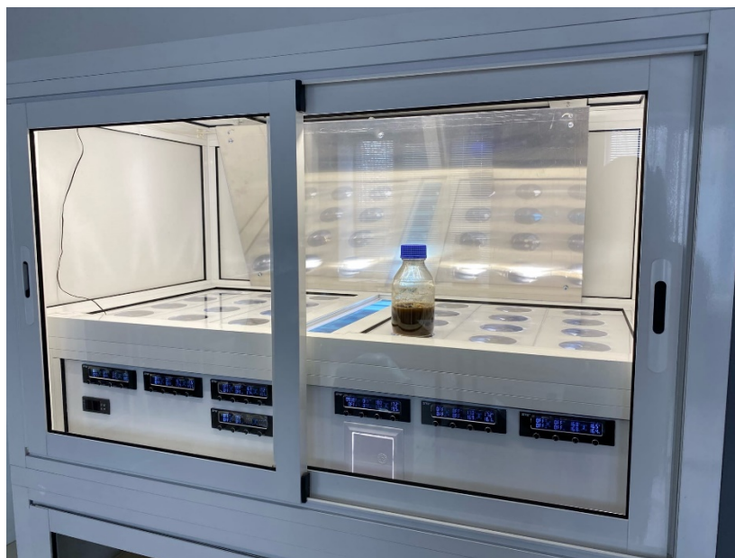
Рис. 1. Экспериментальный прототип шейкера-ферментера, собранный на базе лаборатории фармацевтической биотехнологии НИЧ ФГБОУ ВО «ИГУ».
