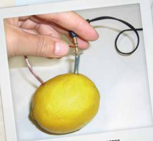
Чтобы возник ток, в лимон втыкается стальной шуруп и медная проволока
