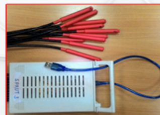
МНОГОКАНАЛЬНАЯ СИСТЕМА РЕГИСТРАЦИИ И ХРАНЕНИЯ ДАННЫХ О ТЕМПЕРАТУРЕ СРЕДЫ.
