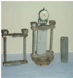
Рис. 1. Определение самонапряжения в динамометрическом кондукторе
