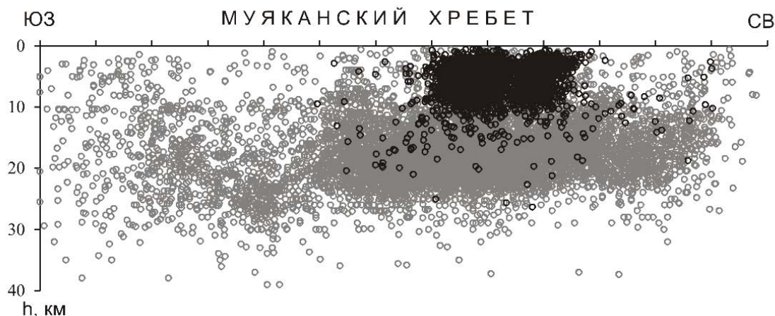
Рис. 3. Распределение гипоцентров землетрясений вдоль разреза в Муяканском хребте (с ЮЗ на СВ): серым цветом обозначены события за период 1970–2013 гг., черным – за период Муяканской активизации (2014–2016 гг.)
